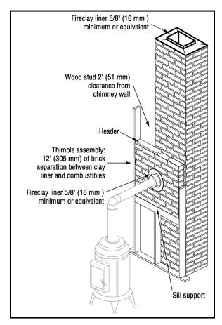
FIGURE 12. MASONRY CHIMNEY
