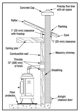
FIGURE 11. MASONRY CHIMNEY
